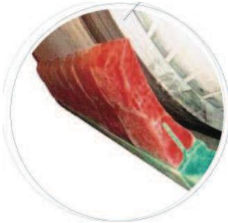
Ubicados frente a la polea de descarga, los raspadores frontales remueven la capa gruesa de material adherido a la correa transportadora, haciendo caer este material junto al flujo principal de descarga.
