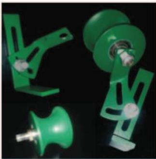
**Concepción:** Polin Hiperbólico es un elemento importante en asegurar que las correas transportadoras mantengan su línea evitando el desplazamiento, como levantamientos y además protegiendo que las correas no se dañen.
